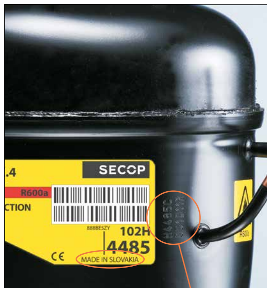
Рис.1 маркировка тиснением на корпусе компрессора и страна происхождения на маркировке типа
